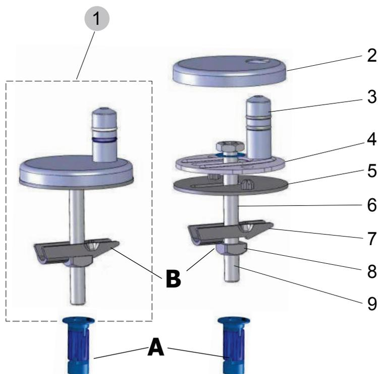
Scharnier-Set mit Befestigung **A** für Keramik mit Sackloch und mit Kippschraub-Befestigung **B** für Durchgangsloch in der Keramik.
